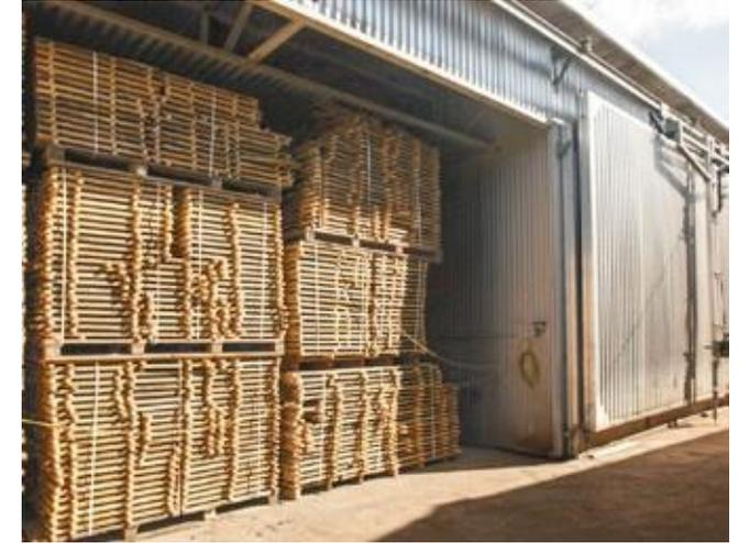
木材干燥设施由意大利DeNARDI的干燥窑组成，以使木材保持高度稳定。干燥窑的总容积为420立方米。
