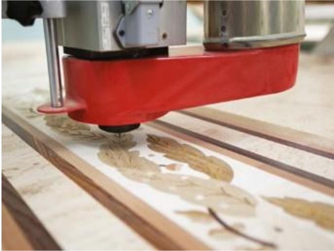
数控设备生产的曲线细节精度可达50微米。
